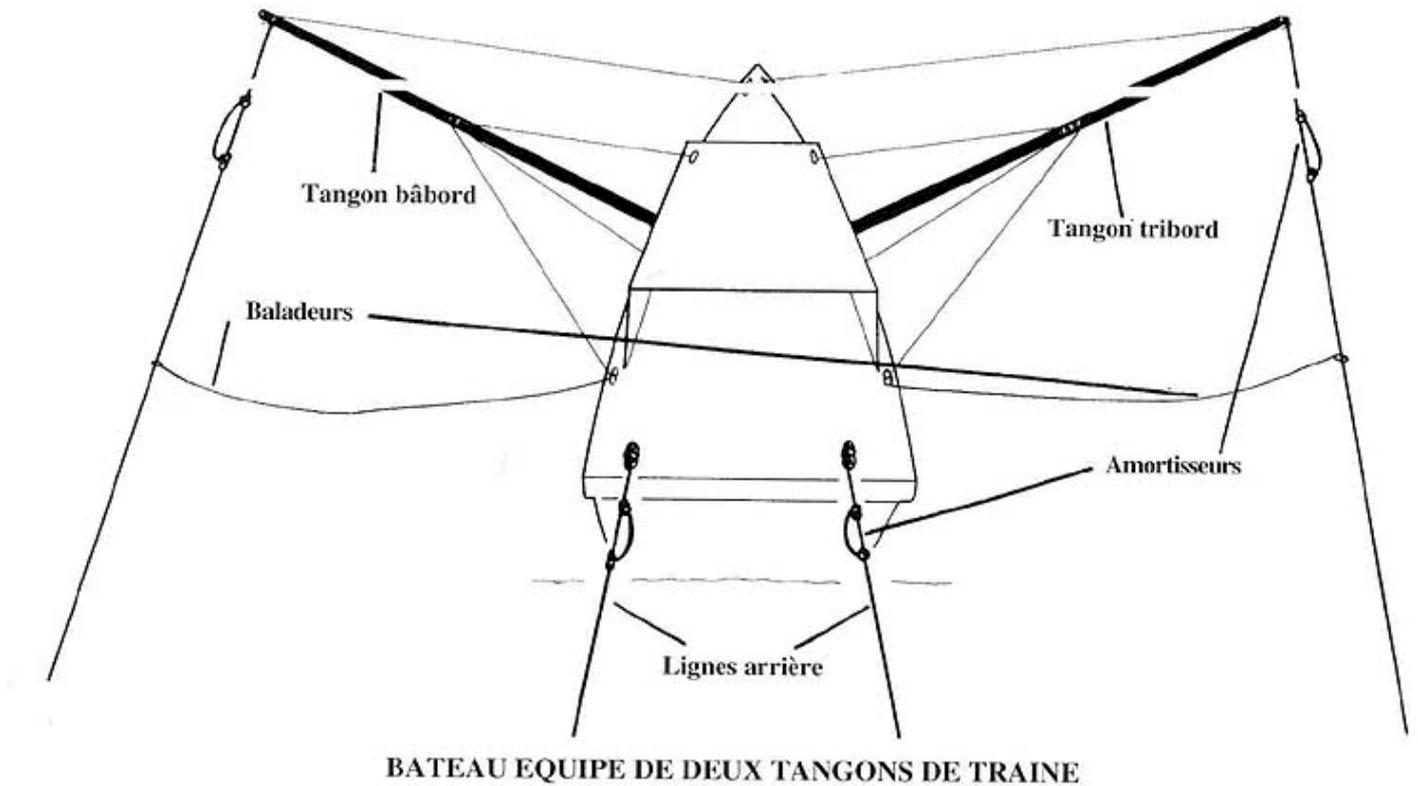
Pour fabriquer des tangons de traîne, on peut utiliser des pièces de bois entières ou équarries, des barres de bois lamellées-collées ou des tuyaux de métal, de fibre de verre ou de plastique. Les meilleurs matériaux sont résistants, raisonnablement souples et légers, ils résistent à la corrosion et sont peu coûteux.
