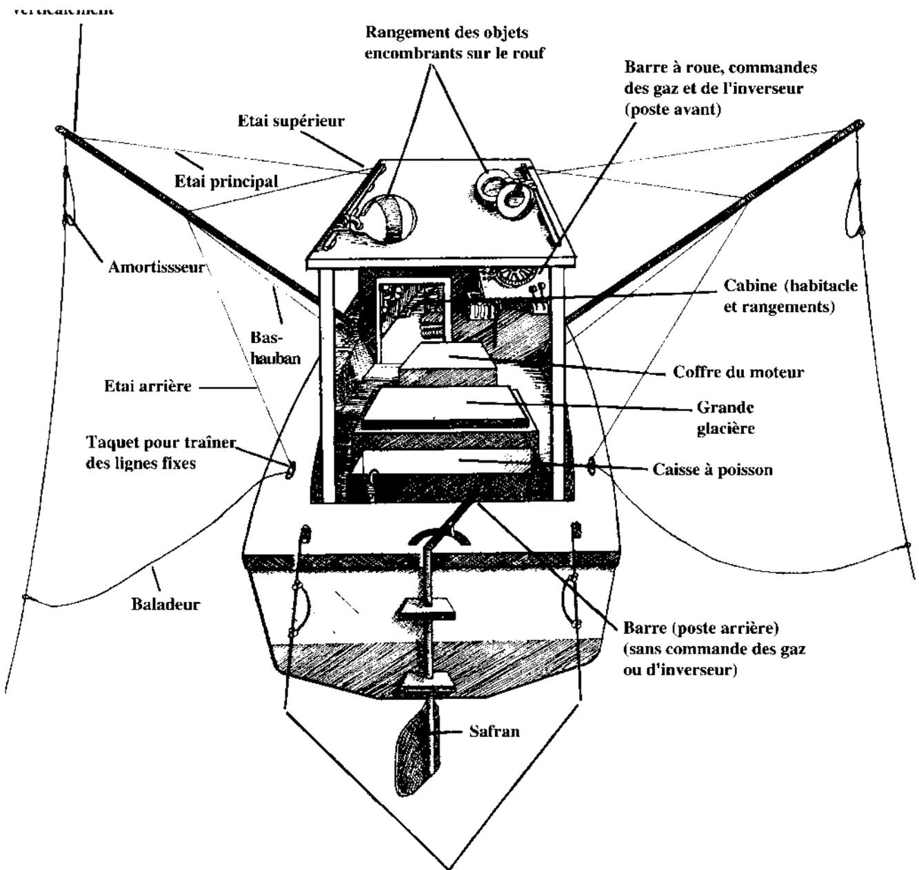
**MONOCOQUE DE 8,5 METRES AVEC FOND EN V ET MOTEUR DIESEL IN-BOARD**
