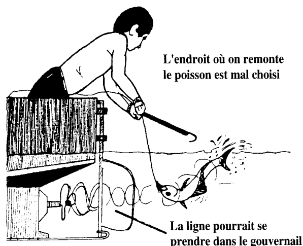
DANS CETTE EMBARCATION LE SAFRAN EMPECHE DE REMONTER LE POISSON PAR L'ARRIERE
