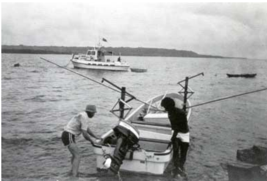
Tangons de traîne en fibre de verre montés sur un canot japonais
